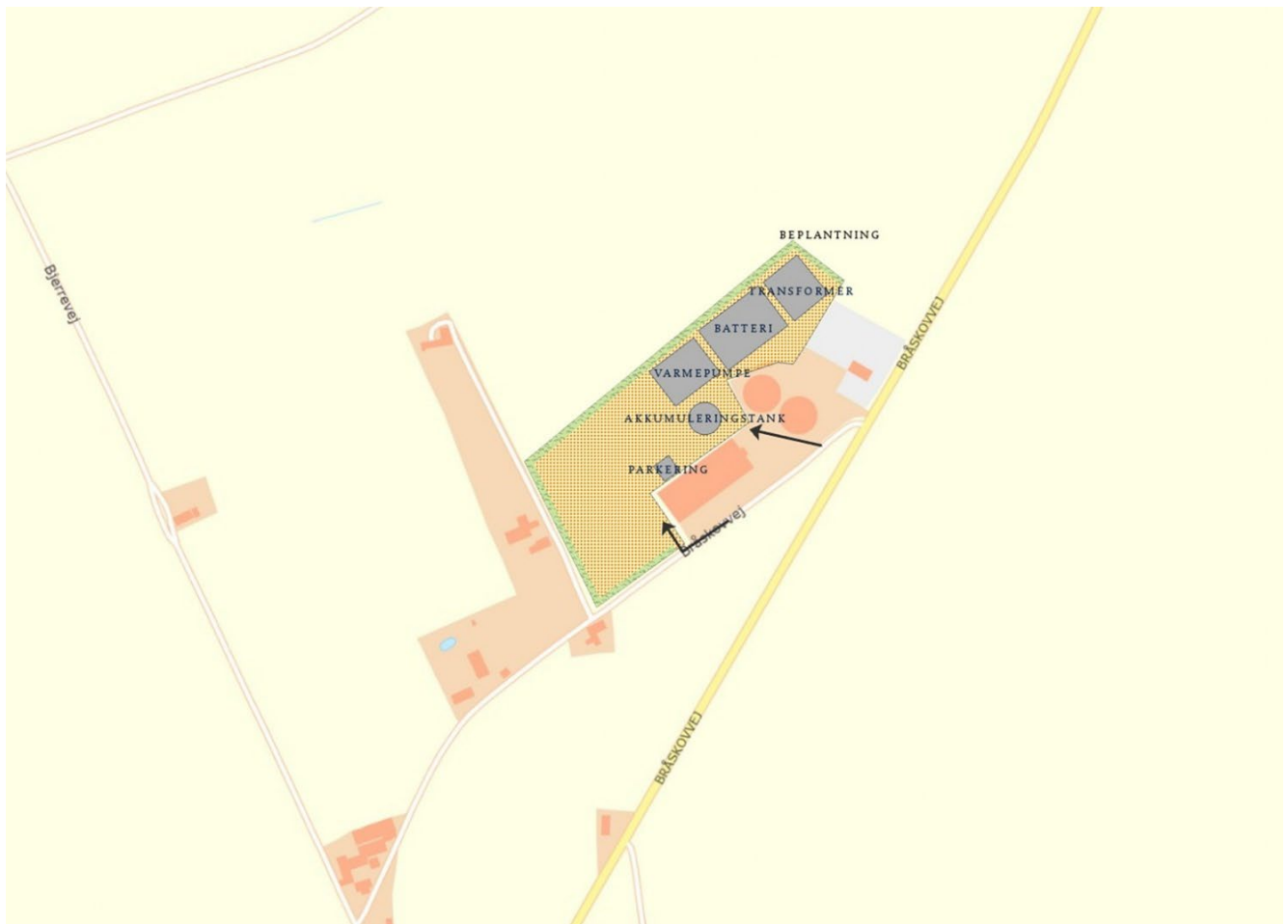
Figur 5-8. Byggefelt med transformerstation, batterianlæg, varmepumpe og akkumuleringsstank
