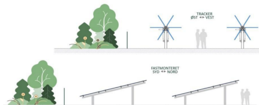
Figur 2. Typer af solcellepaneler. Øverst Single-axis tracker paneler, der følger solens bane over himlen. Nederst sydvendte fastmonterede paneler.
