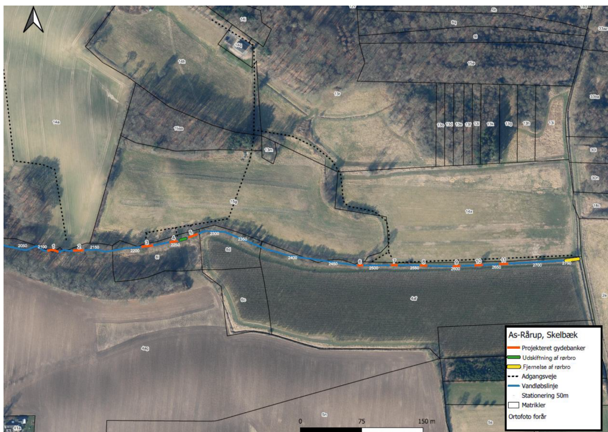
Figur 4.2 Tiltagskort fra ansøgningsmateriale. To rørbroer og gydebanks 1-11.
