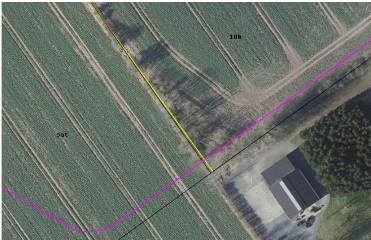
Ortofoto 2025 © Hedensted Kommune. Kabeltracée er vist med lilla streg og beskyttet dige med gul streg. Digestrækning matr. 5at og 18k, Hedensted By, Hedensted.
