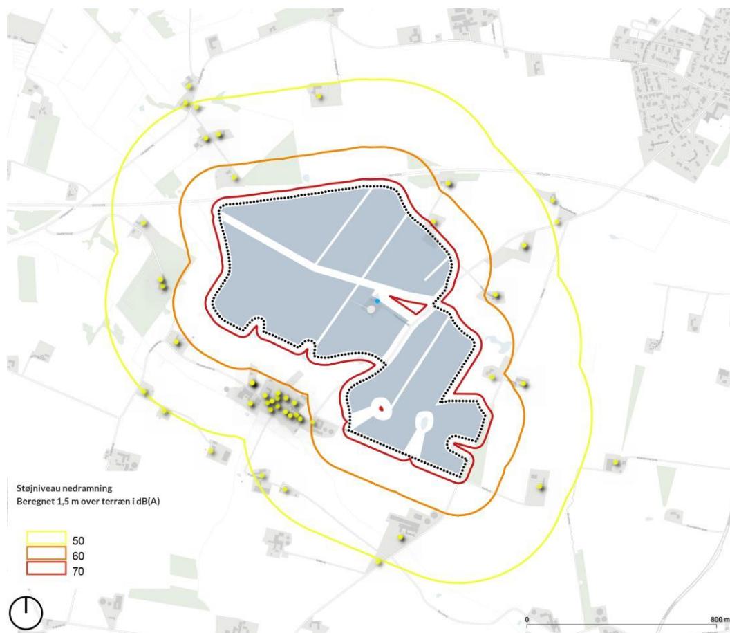
Figur 10.3: Støjudbredelse ved nedramning af stativer til solcelleanlæg ud for den enkelte ejendom. Inden for den røde linje vil man opleve støj over vurderingskriteriet på 70 dB(A) i en periode.
