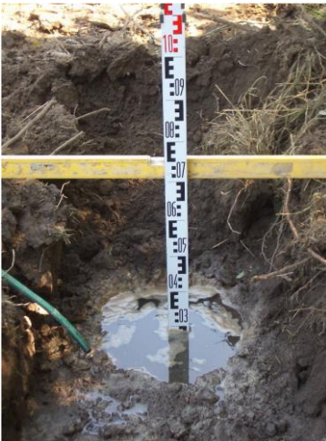
Foto 2: målestok placeres på hullets bund, som er infiltrationsniveau, med en retskinne for aflæsning.
