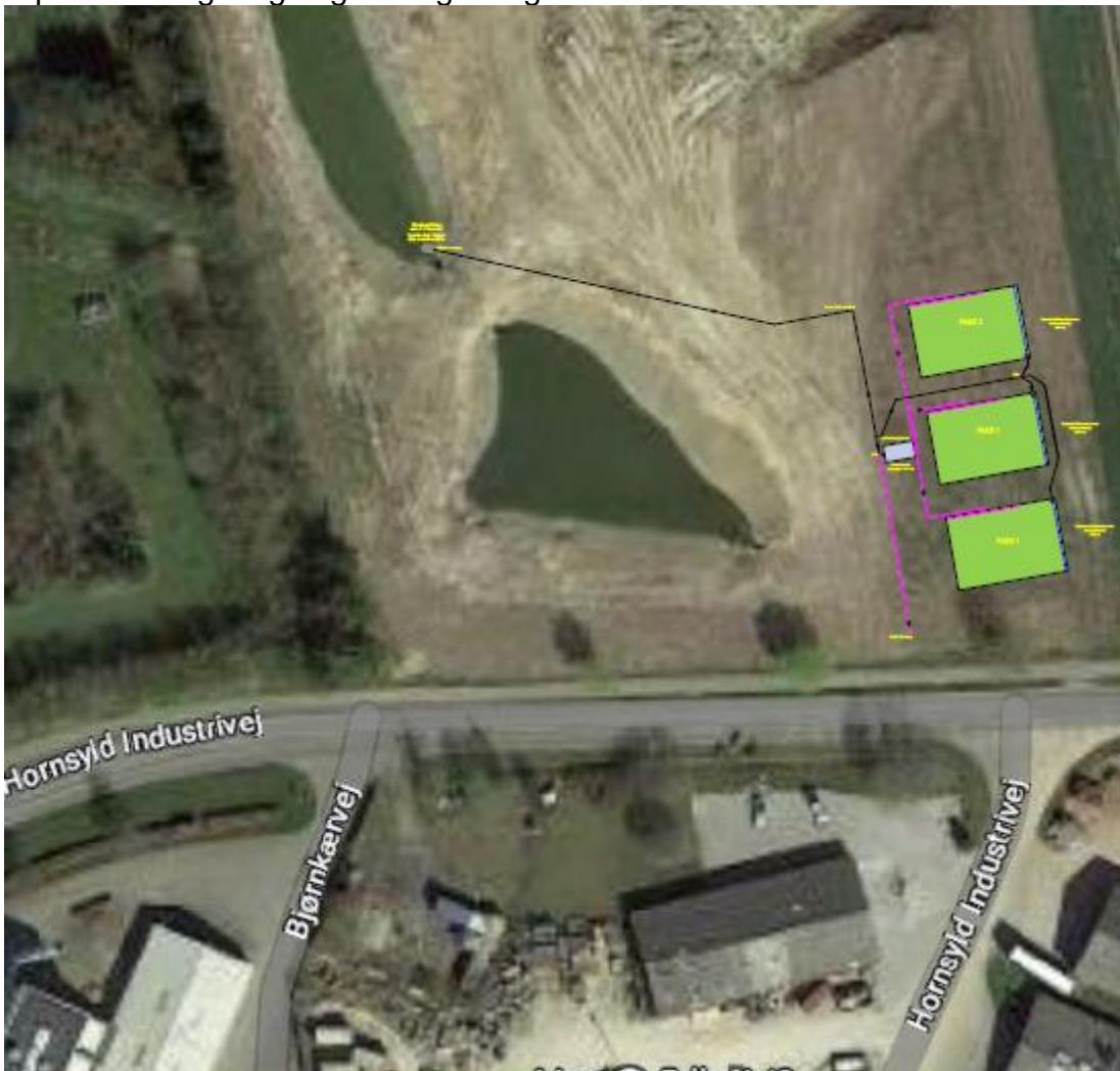
Figur 15. Klip fra oversigtstegningen (bilag 7) med udledning på nordsiden af det rør der forbinder de to udgravninger.
