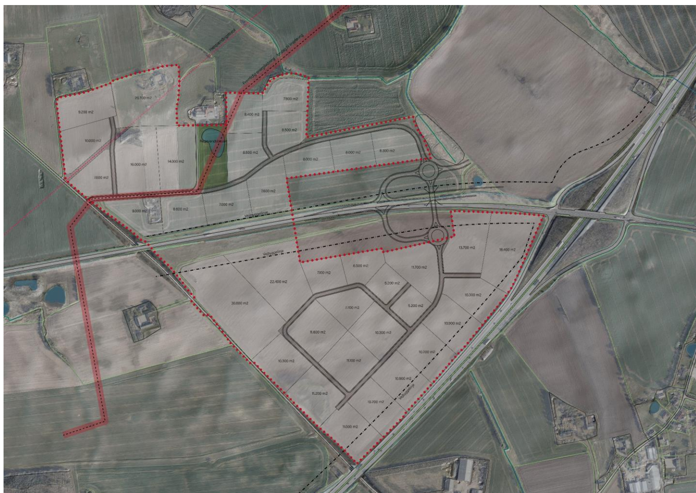
Figur 6.1 Illustrationsplan der viser en mulig disponering af området. Den brede røde linje viser en potentiel linjeføring for Energinets planlagte ledningstracé.
