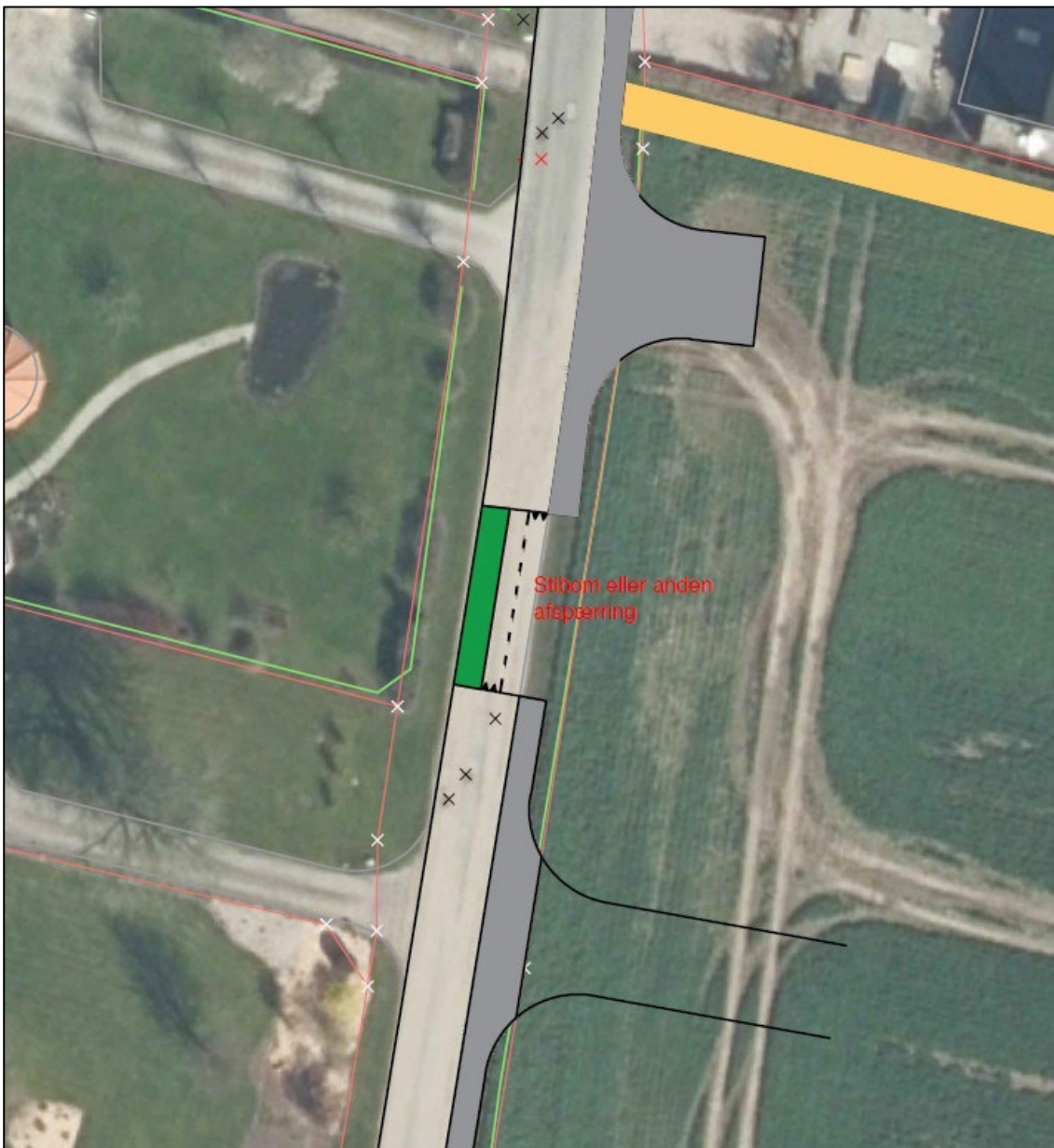
Figur 12. Etablering af vendeplads til 12 m lastbil. Gul skravering viser areal, der skal erhverves.
