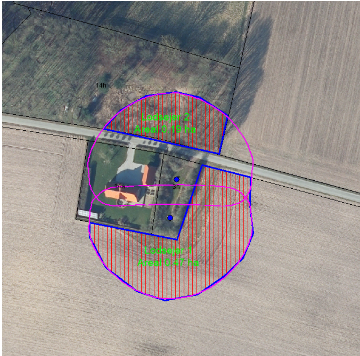
Figur 1 Arealer ved Rårup Vandværk, som ikke må sprøjtes fremadrettet, er markeret med blåt og skraveret med rødt. BNBO er markeret med lilla omrids. Vandværkets borerer er markeret med blå prikker.
