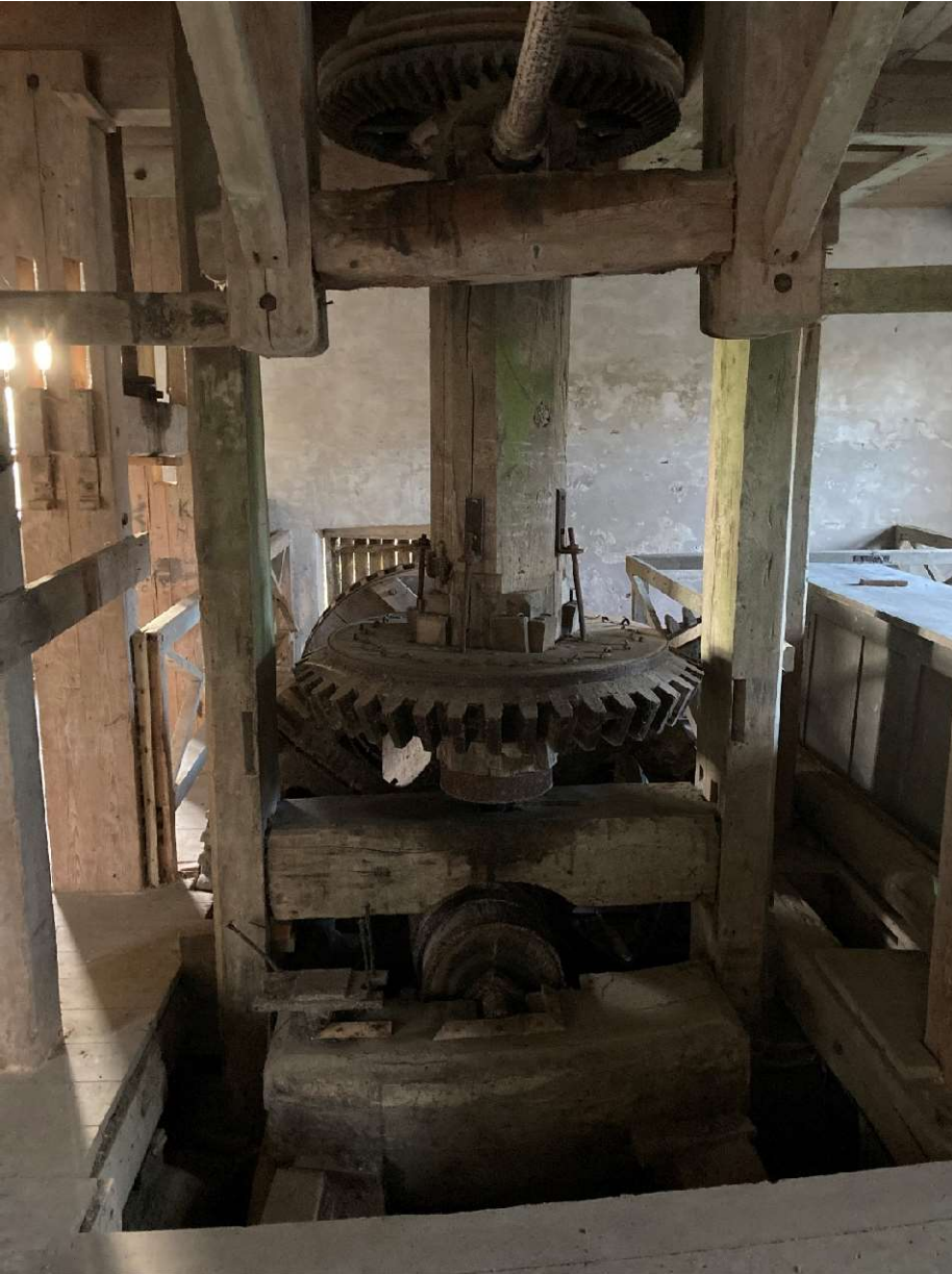
Detalje af hvordan trækakslen (jærnstangen øverst i billedet) indgår i møllens maskineri.
