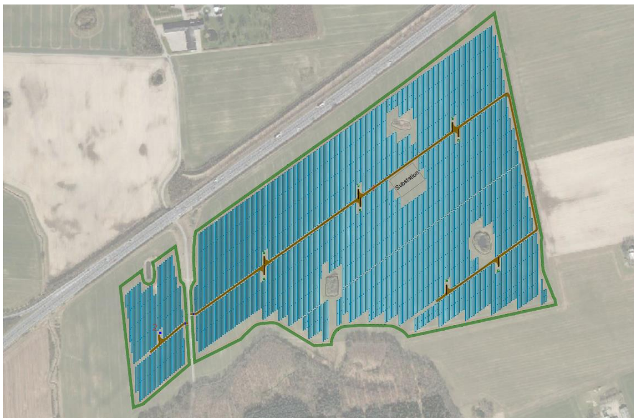
Figur 3-2 Vejledende parklayout for solcelleanlæg på trackerstativer.
