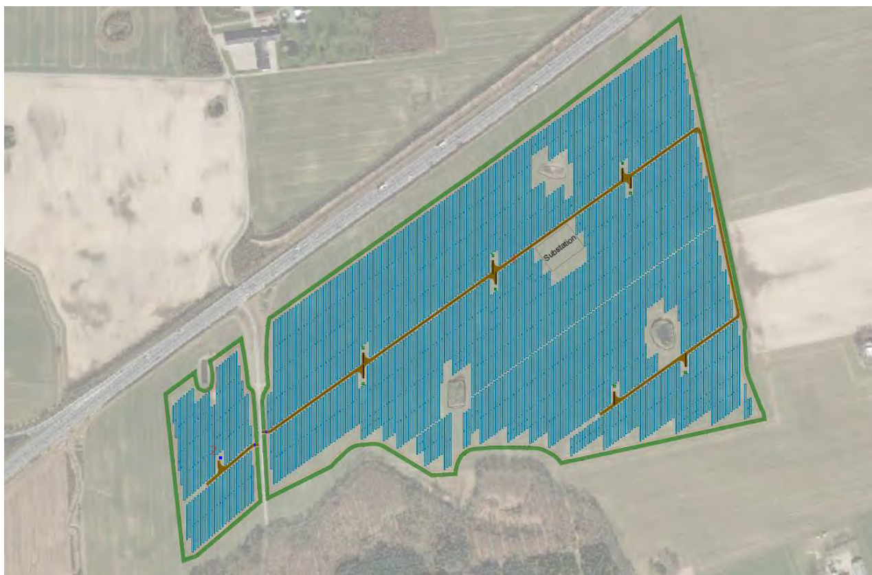
Figur 3-2 Vejledende parklayout for solcelleanlæg på trackerstativer.
