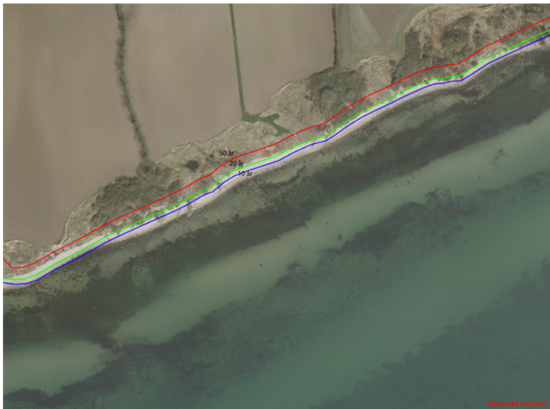
Kortudsnit af den forventet kysttilbagerykning på grund af moderat kronisk erosion.
