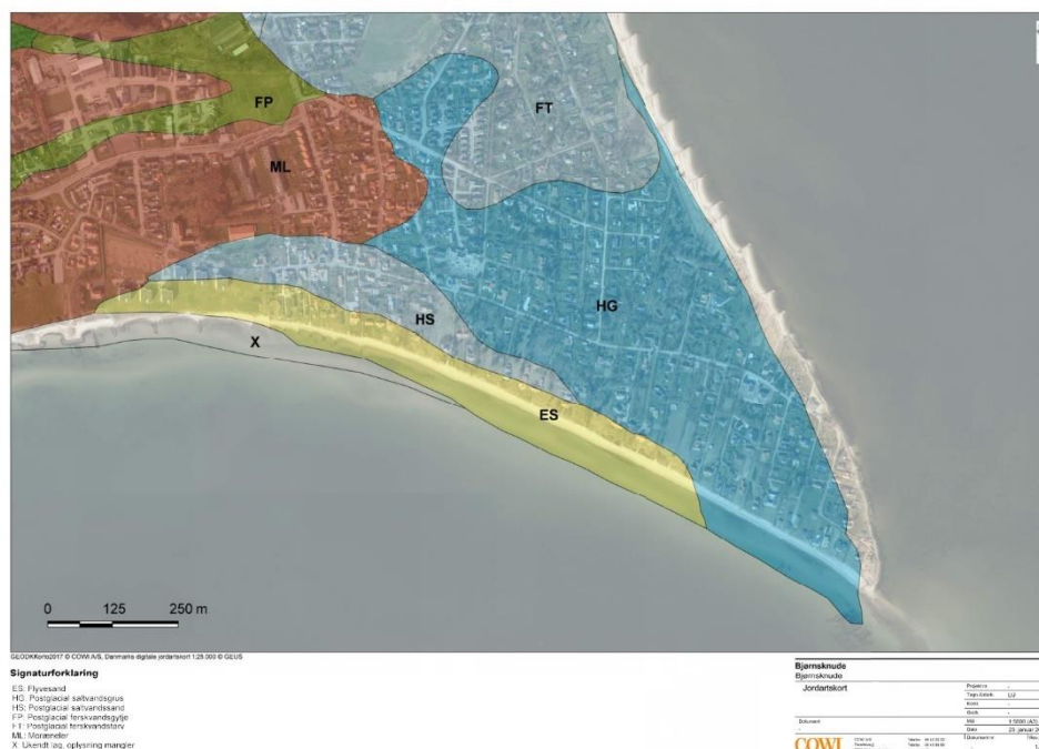
Figur 5-1 Geologisk grundkort. Det bemærkes, at der ses en forskydning i det geologiske kortlag i forhold til grundkortet. Det skyldes en fejl i GEUS' kortdatabase og kan således ikke umiddelbart justeres.
