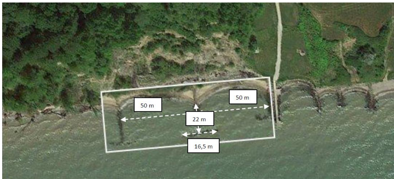
Kort 2. Illustration fra ansøgning med ønsket kystsikring ved kystområdet på matr. nr. 3n, Sønderby By, Glud. Etablering af to T-høfder med dimensioner og afstand (fra ansøgningen).
