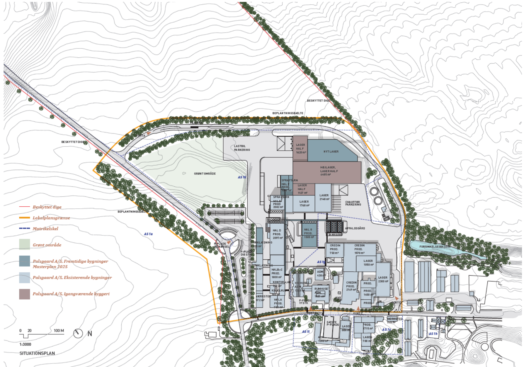
Bebyggelsesplan, der viser den fremtidige udbygning af planområdet. Det planlagte spraytårn er benævnt Hal F.
