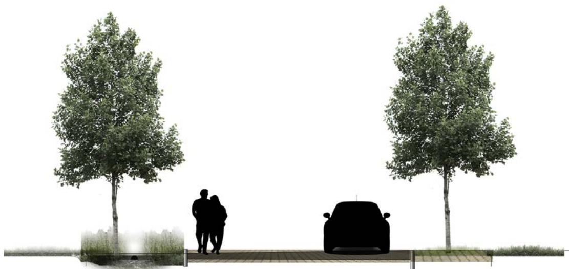
Eksempel på vejsnit med grøn regnvandsrende
