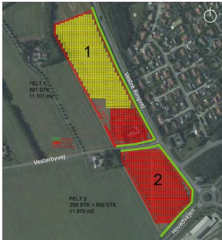
Figur 3: Forslag til disponering af solpaneler med tilhørende teknikbygning, tank, vejadgang, parkering, plantebælter mv..
