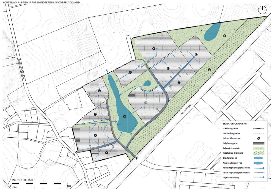
Princip for håndtering af overfladevand
