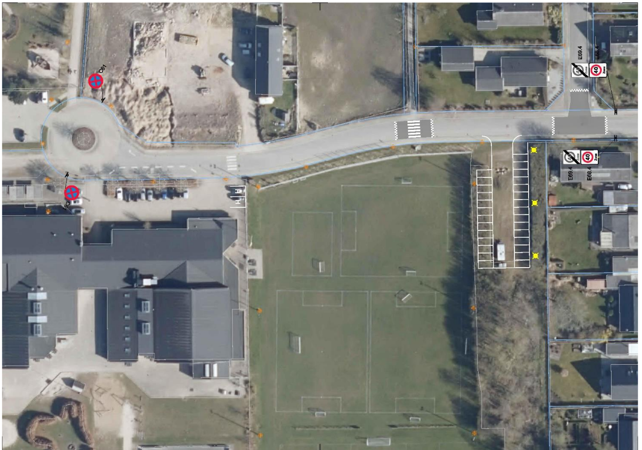
Figur 2 Trin 1 – hastighedsdæmpning og etablering af 28 afmærkede parkeringspladser på grusområde.
