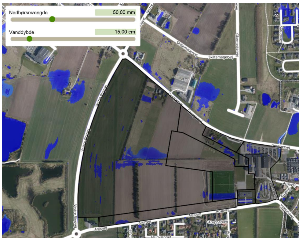
Figur 5. Lavninger med en dybde på >15 cm.
