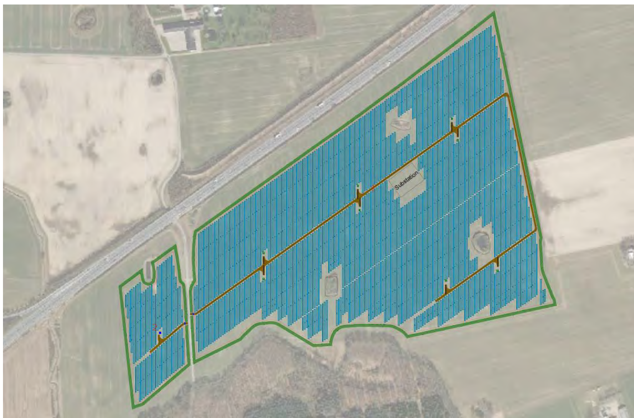
Figur 3-2 Vejledende parklayout for solcelleanlæg på trackerstativer.
