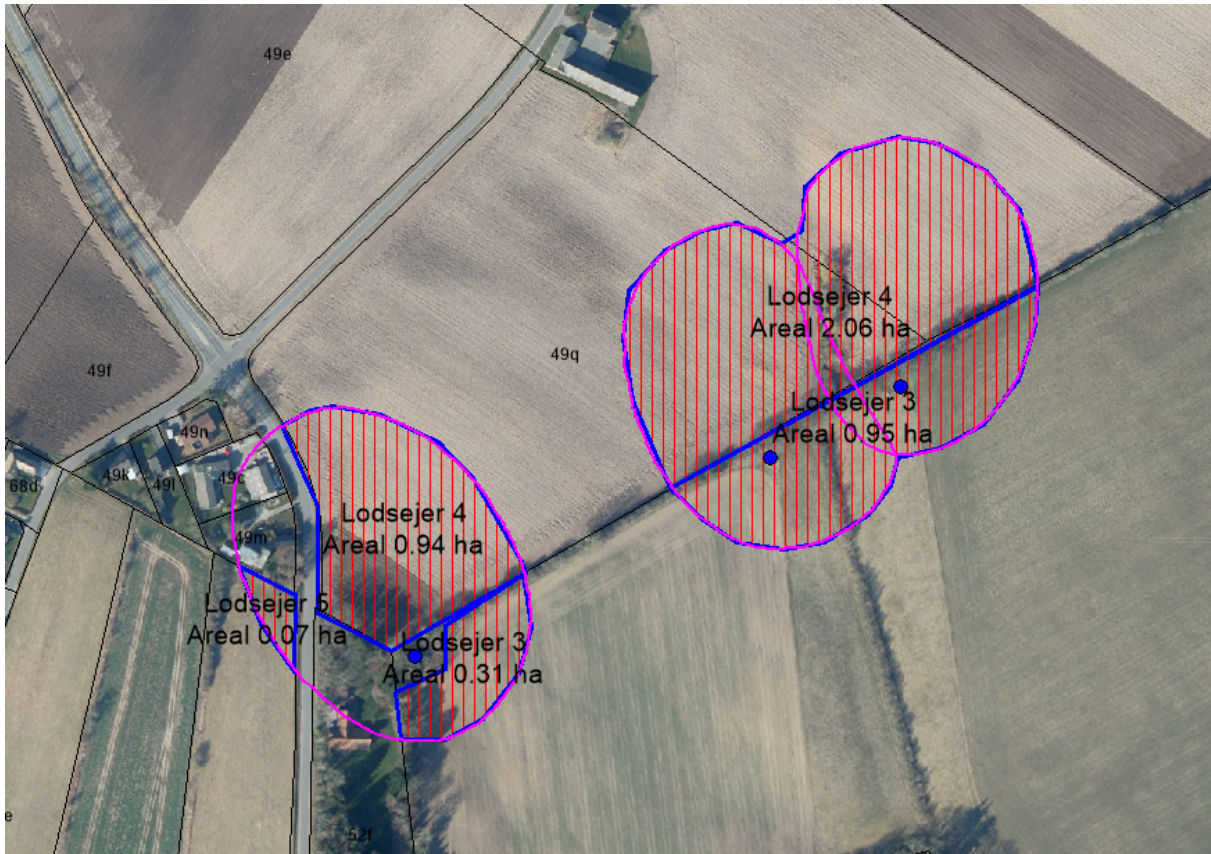
Figur 1 Arealer ved Juelsminde Vand på kildepladsen ved Barrit, som ikke må sprøjtes fremadrettet, er markeret med blått og skraveret med rødt. BNBO er markeret med lilla omrids. Vandværkets borer er markeret med blå prikker.
