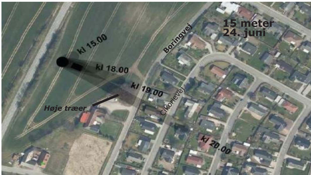
Figur 4.3.2 Skyggediagram i juni for tank (runde signatur) med en højde på 15 meter.
