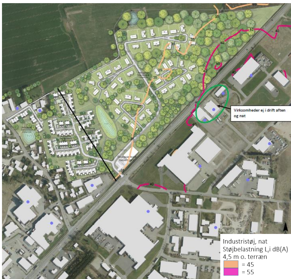
Figur 5-7 Beregnet udbredelse af industristøj i nattetimerne i 4,5 meters højde. Blå punkter markerer støjkilder på virksomhederne (bemærk at sort streg ikke har en betydning for vurderingen, samt at illustrationsplanen stammer fra et ældre forslag og således ikke viser det aktuelle planforslag).
