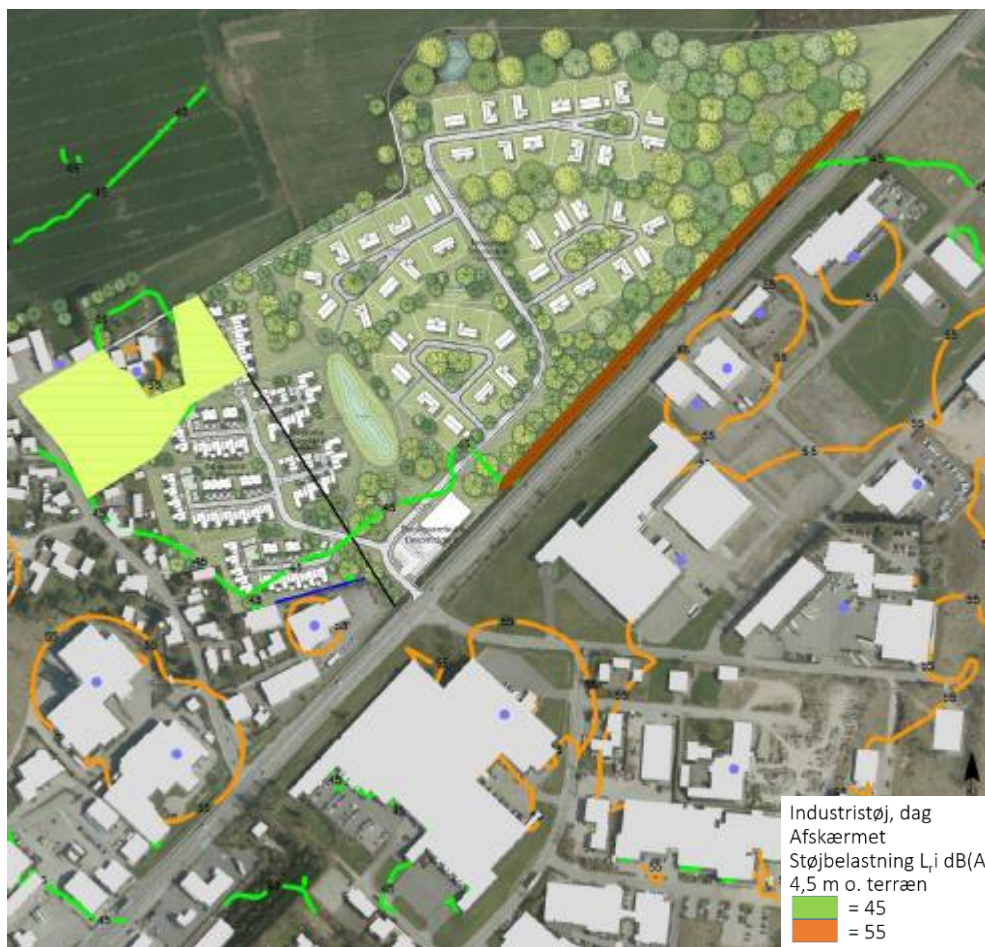
Figur 5-11 Støjkort med påvirkningen af planområdet med industristøj, når der er etableret en støjvold på cirka 450 meters længde med en højde på 5,5 m. Støjkortet viser støjvolden i 4,5 meters højde i planområdet. (Bemærk at lysegrøn flade og sort strek ikke har en betydning for vurderingen, samt at illustrationsplanen stammer fra et ældre forslag og således ikke viser det aktuelle planforslag).
