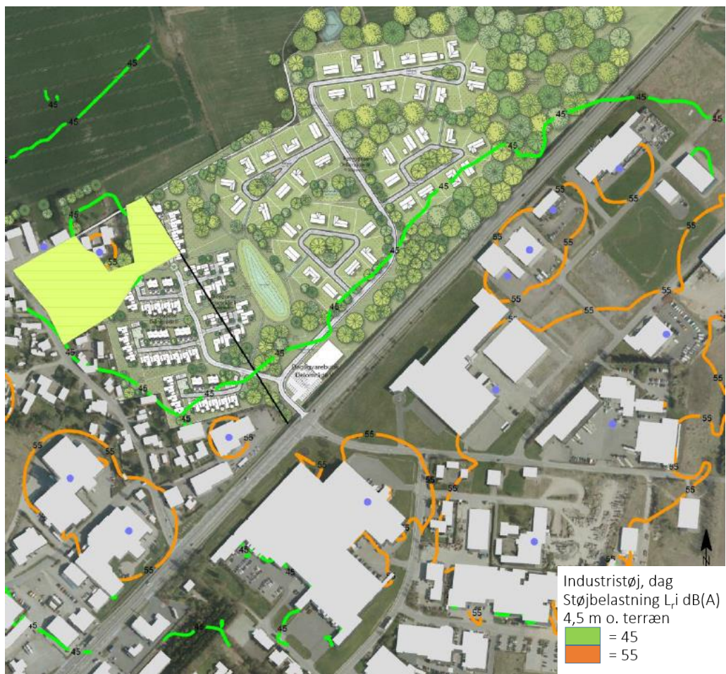
Figur 5-5 Beregnet udbredelse af industristøj i dagtimerne i 4,5 meters højde. Blå punkter markerer støjkilder på virksomhederne (bemærk at lysegrøn flade og sort streg ikke har en betydning for vurderingen, samt at illustrationsplanen stammer fra et ældre forslag og således ikke viser det aktuelle planforslag).
