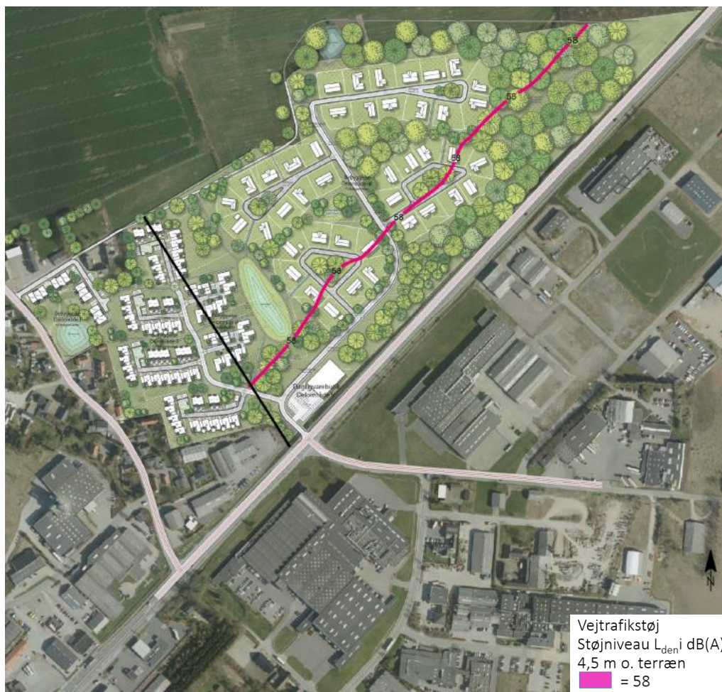
Figur 5-3 Støjudbredelse fra trafikken på Hovedvejen (vest-øst retning) samt Remmerslundvej (syd-nordlig retning) i Hedensted, ind mod planområdet i 4,5 meters højde. (Illustrationsplanen stammer fra et ældre forslag og viser således ikke det aktuelle planforslag).
