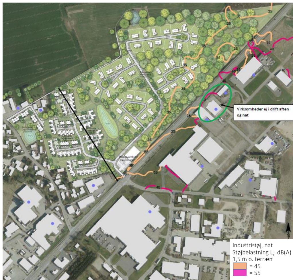
Figur 5-6 Beregnet udbredelse af industristøj i nattetimerne i 1,5 meters højde. Blå punkter markerer støjkloder på virksomhederne (bemærk at sort streg ikke har en betydning for vurderingen, samt at illustrationsplanen stammer fra et ældre forslag og således ikke viser det aktuelle planforslag).
