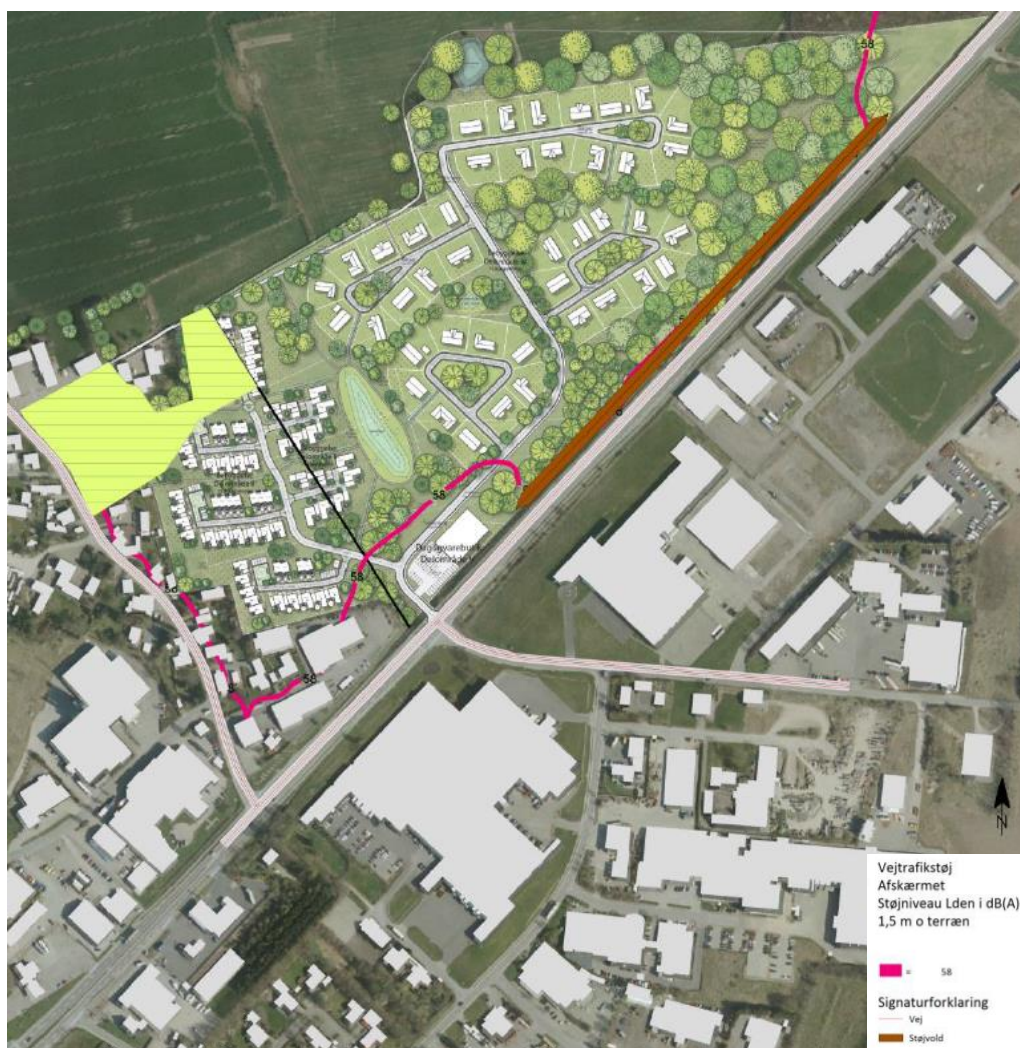
Figur 5-8 Støjkort med påvirkningen af planområdet med trafikstøj, når der er etableret en støjvold på cirka 450 meters længde med en højde på 5,5 m. Støjkortet viser støjdbredelsen i 1,5 meters højde i planområdet. (Bemærk at lysegrøn flade og sort streg ikke har en betydning for vurderingen, samt at illustrationsplanen stammer fra et ældre forslag og således ikke viser det aktuelle planforslag).
