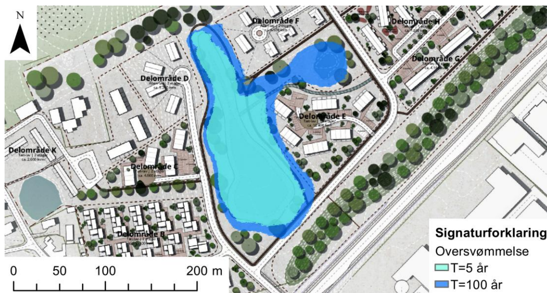
Figur 5-21 Udbredelse af regnvolumen ved hhv. en gentagelsesperiode på 5 år og 100 år (ekstremregn) på terræn.
