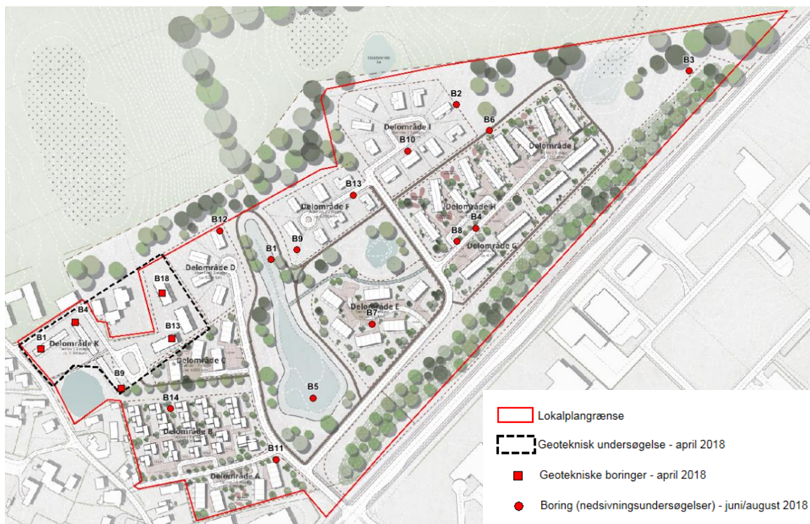
Figur 5-16. Boringer udført i hhv. juni (B1 – B5) og august (B6 – B14) 2018 er markeret med rød prik. Derudover fremgår 5 udvalgte boringer fra geoteknisk undersøgelse udført i april måned 2018 (rød firkant).
