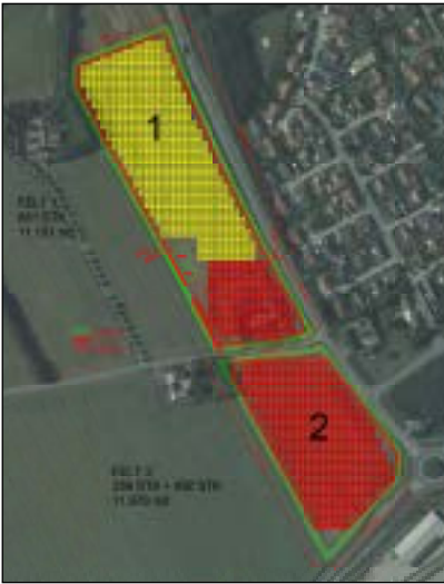
Figur 2: Solvarmeanlæggets opdeling i etaper.
