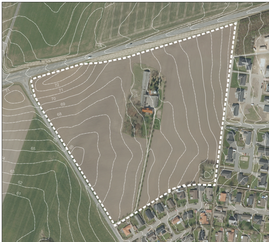
Luftfoto, med indtegnede koter, der viser arealets store terrænforskelle.
