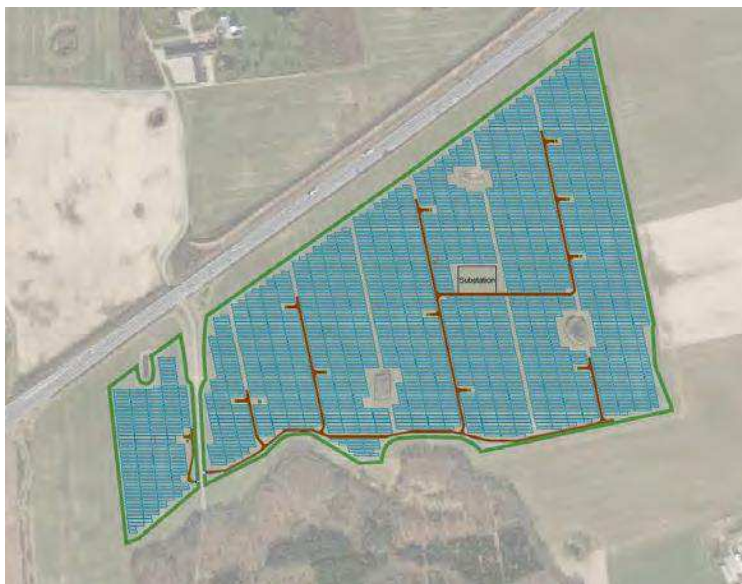
Figur 2 Variant med sydvendte faste rækker
