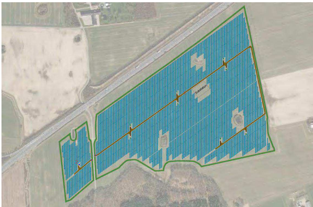
Figur 3-2 Vejledende parklayout for solcelleanlæg på trackerstativer.
