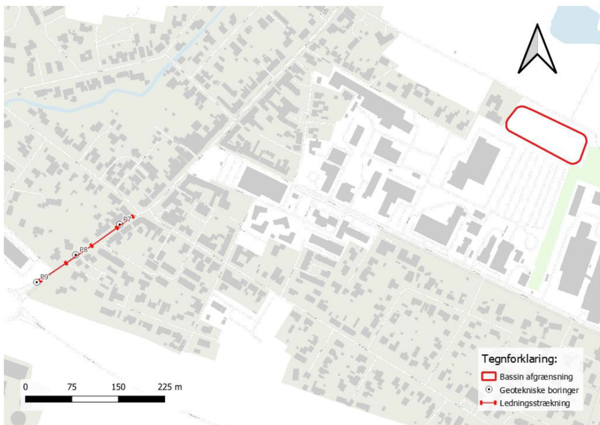
Figur 1 Oversigtskort med angivelse af ledningsstrækning, lokalitet for de udførte geotekniske boringer samt angivelse af det eksisterende regnvandsbassin.
